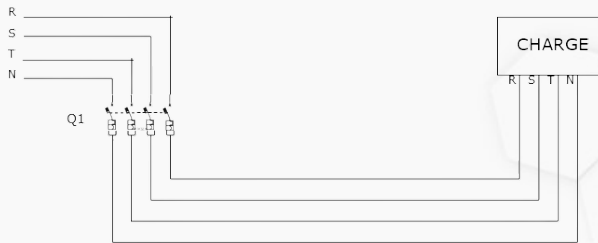
Diagramme de pré-installation SANS système ICO-F
